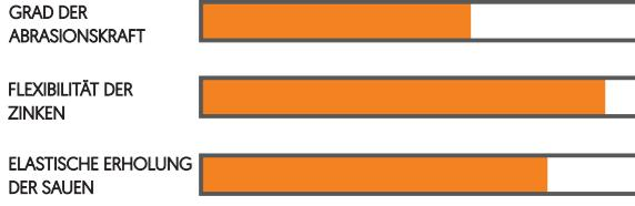
Geignet für die Entfernung von mittelharten, fettigen Rückständen. Nylonbürsten sind sehr empfehlenswert für Kombinationen in Kanälen mit Misch- oder PBT-Bürsten. Sie sind ideal für die Unterhaltsreinigung. Sie zerkratzen nicht das Innere des Kanals. Sie sorgen für eine optimale Schaumverteilung.
