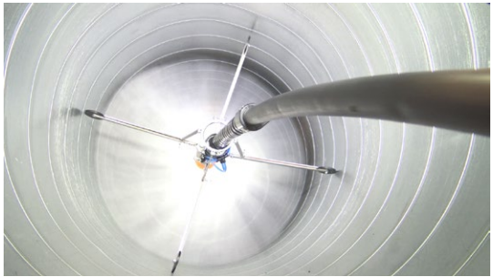
El centrador fija el cepillo en el centro de conducto.
