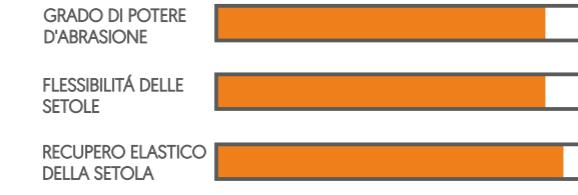
Il PBT è adatto alla rimozione di residui grassi di media durezza con elevate proprietà abrasive e disincrostanti. Il PBT è una delle materie prime più recenti e tecnologicamente avanzate, con un eccellente recupero elastico. Non rilascia sostanze ed è certificato secondo gli standard internazionali, rendendolo adatto all'uso in aree alimentari. Non graffiano l'interno del condotto.
