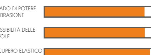
PBT [Polibutilene tereftalato] Indicato per residuo grasso di durezza medio-alta con alto potere di abrasione e disincrostazione del grasso. Il PBT è una delle più recenti materie prime di concezione, tecnologicamente più avanzato e con eccellente recupero elastico. Non rilascia sostanze, certificato da standard internazionali che lo rendono adatto all'uso in ambienti alimentari.
