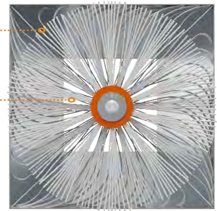
Os módulos foram concebidos para combinar duas escovas de diferentes diâmetros, material e espessura de puas, a fim de adaptar a escovagem à forma da conduta, tanto em condutas circulares como quadradas. O sistema DUO Square combina duas filas de escovas, o núcleo exterior é dimensionado para a altura da conduta e o núcleo interior para o tamanho adequado para conseguir uma escovagem eficaz no canto.
