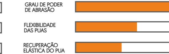
MIXTO (combinação de aço e nylon) Adequado para a remoção de resíduos de gorduras extremamente duras. Muito adequado para a remoção de graxa "carbonizada". O aço quebra a gordura, permitindo que o resíduo químico se disperse, com o nylon a distribuir a penetração da espuma activa no resíduo. Máxima capacidade de abrasão.
