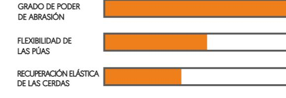
MIXTO (combinación de acero y nailon) Indicado para la eliminación de residuos grasos extremadamente duros. Muy adecuado para la eliminación de la grasa "carbonizada". El acero rompe la grasa, permitiendo que el residuo químico se disperse, con nylon que distribuye la penetración de la espuma activa en el residuo. Máxima capacidad de abrasión.
